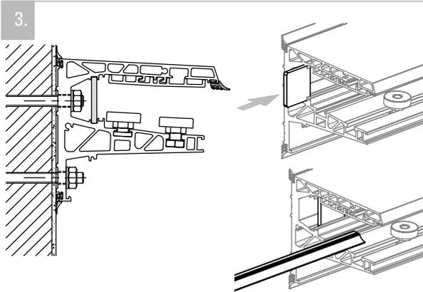
Die Anschlagstücke und die obere Dichtung in das Basisprofil einschieben. Die Anzahl der Anschlagstücke variiert je nach Profil Länge. **Abbildung B.**
