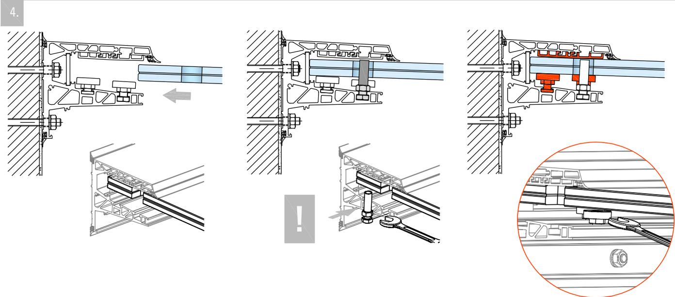
**Glas Installation:** Die Glasscheibe zwischen die Einstellschrauben und das Ausgleichsprofil führen. Das Glas muss dabei bis an die hintern Anschlagstücke stoßen. Danach muss das Glas mit den Einstellschrauben an das obere Ausgleichsprofil gebracht werden.
