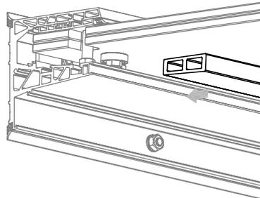
Klemmp Profile zwischen Glas und Basisprofil einpressen. Die Anzahl Klemmp Profile variiert je nach Profil Länge. **Abbildung C.**
