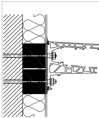
Bei der Montage auf Wärmedämmverbundsystemen (WDVS) empfehlen wir die Verwendung von HIK Iso-Konsolen der Firma HILTI. Mehr Infos unter: [www.hilti.de](http://www.hilti.de)
