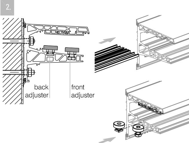
Das obere Ausgleichsprofil und die Einstellschrauben in das Basisprofil einsetzen. Die Anzahl der Schrauben variiert je nach Profil Länge. Es gilt zu beachten das die vorderen und hinteren Einstellschrauben nicht in einer Achse zu einander liegen. Damit sie gut mit dem Schraubenschlüssel zu erreichen sind. **Abbildung A.**
