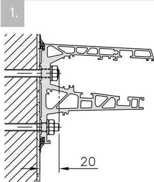
Das Basisprofil (inkl. Dichtungen) mit statisch geeignetem Befestigungs-Ankern\* an der Wand befestigen. Dabei müssen alle Montage Bohrlöcher benutzt werden. Das Profil sollte als Bohrschablone benutzt werden.
