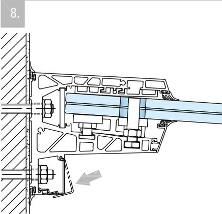
Schraubenabdeckung an das Basisprofil ansetzen und bis zum einrasten andrücken. Alternativ und wenn genug Platz vorhanden ist, kann das Schraubenabdeckungsprofil auch seitlich in das Basisprofil eingeschoben werden.
