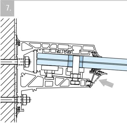
Profilabdeckung inkl. Dichtung an das Basisprofil ansetzen und in das Basisprofil bis zum einrasten andrücken.
