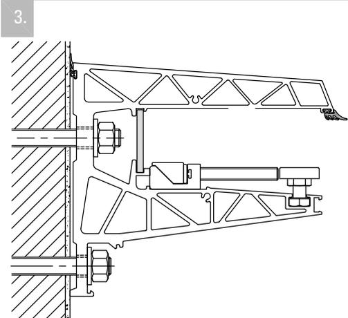
Die Anschlagstücke und die obere Dichtung in das Basisprofil einschieben. Die Anzahl der Anschlagstücke variiert je nach Profil Länge. **Abbildung B.**
