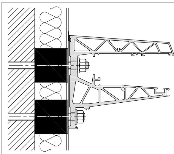
Bei der Montage auf Wärmedämmverbundsystemen (WDVS) empfehlen wir die Verwendung von HIK Iso-Konsolen der Firma HILTI. Mehr Infos unter: [www.hilti.de](http://www.hilti.de)
