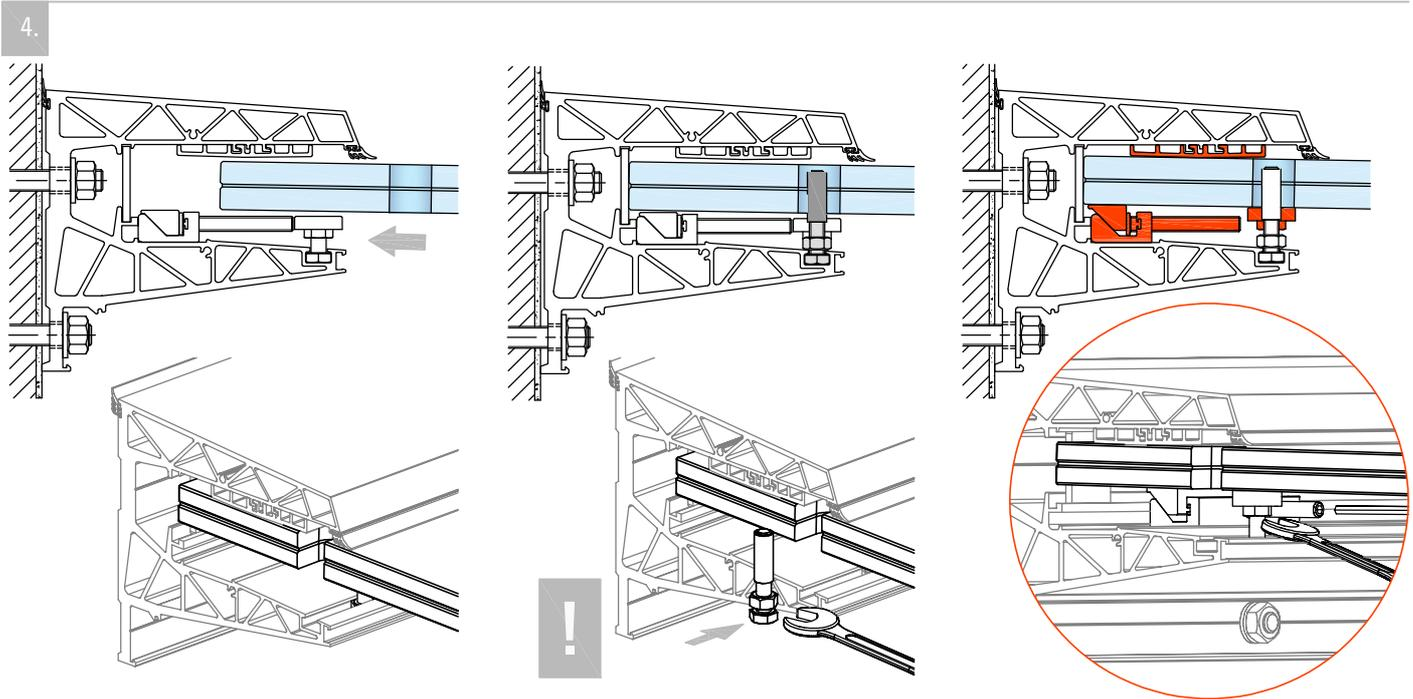
**Glas Installation:** Die Glasscheibe zwischen die Einsteller und das Ausgleichprofil führen. Das Glas muss dabei bis an die hintern Anschlagstücke stoßen. Danach muss das Glas mit den Einstellern an das obere Ausgleichprofil gebracht werden.
