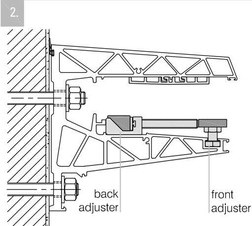
Das obere Ausgleichsprofil, die Einstellschrauben (Front) und Schraubblöcke (Back) in das Basisprofil einsetzen. Die Anzahl der Einsteller variiert je nach Profil Länge. Es gilt zu beachten das die vorderen und hinteren Einsteller nicht in einer Achse zu einander liegen. Damit sie gut mit einem Sechskant- und Schraubenschlüssel zu erreichen sind. **Abbildung A.**
