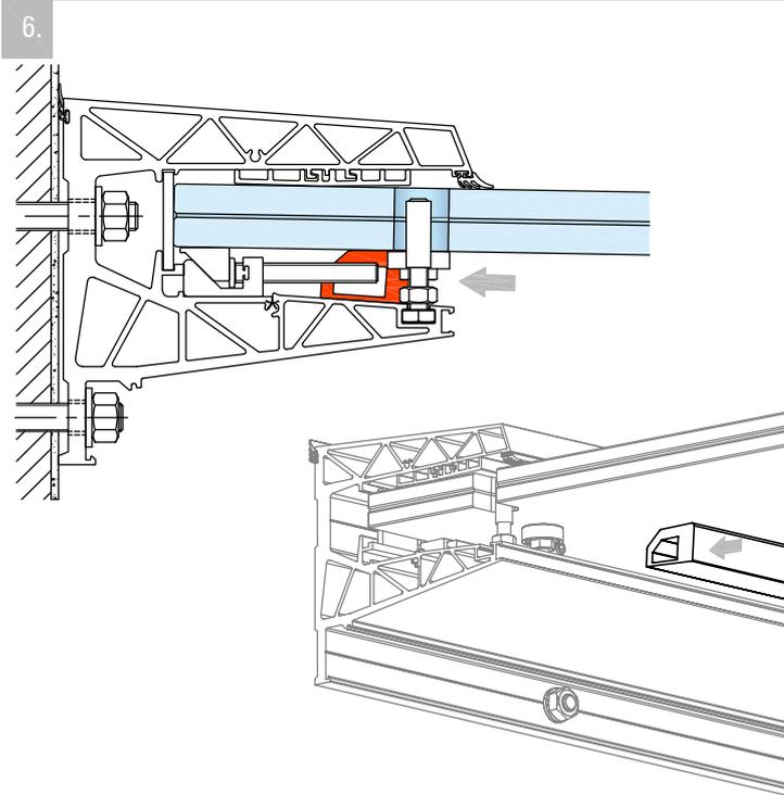
Klemmprofile zwischen Glas und Basisprofil einpressen. Die Anzahl Klemmprofile variiert je nach Profil Länge. **Abbildung C.**
