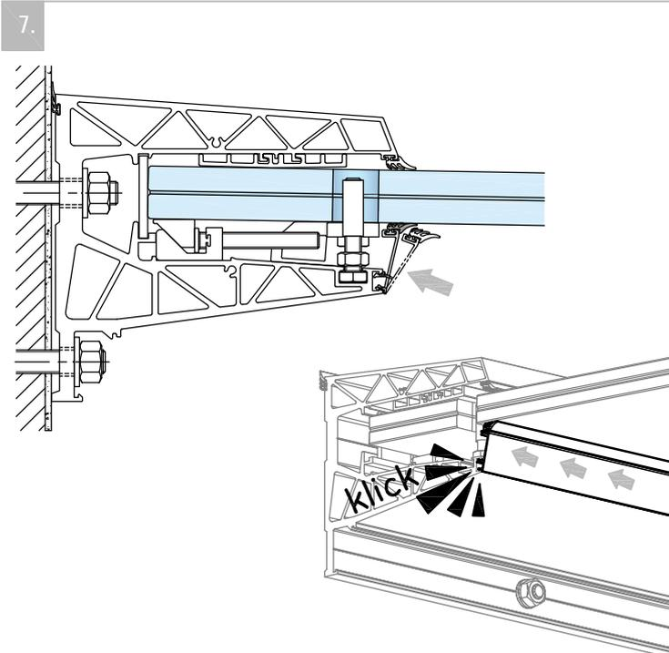
Profilabdeckung inkl. Dichtung an das Basisprofil ansetzen und in das Basisprofil bis zum einrasten andrücken.
