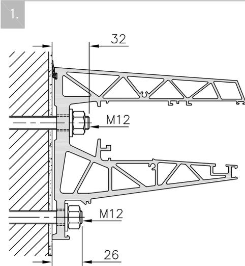
Das Basisprofil (inkl. Dichtungen) mit statisch geeignetem Befestigungs-Ankern\* an der Wand befestigen. Dabei müssen alle Montage Bohrlöcher benutzt werden. Das Profil sollte als Bohrschablone benutzt werden.
