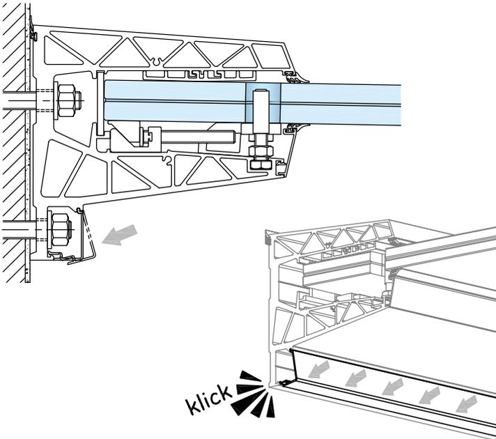
Schraubenabdeckung an das Basisprofil ansetzen und bis zum einrasten andrücken. Alternativ und wenn genug Platz vorhanden ist, kann das Schraubenabdeckungsprofil auch seitlich in das Basisprofil eingeschoben werden.
