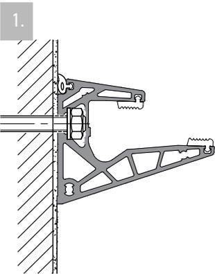
Das Basisprofil mit statisch geeignetem Befestigungs-Ankern\* an der Wand befestigen. Dabei müssen alle Montage Bohrlöcher benutzt werden. Das Profil sollte als "Bohrschablone" verwendet werden. Die Abmessung von 200mm zwischen den Montagelöchern gilt nur als circa Maß.
