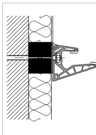
Bei der Montage auf Wärmedämmverbundsystemen (WDVS) empfehlen wir die Verwendung von HIK Iso-Konsolen der Firma HILTI. Mehr Infos unter: [www.hilti.de](http://www.hilti.de)
